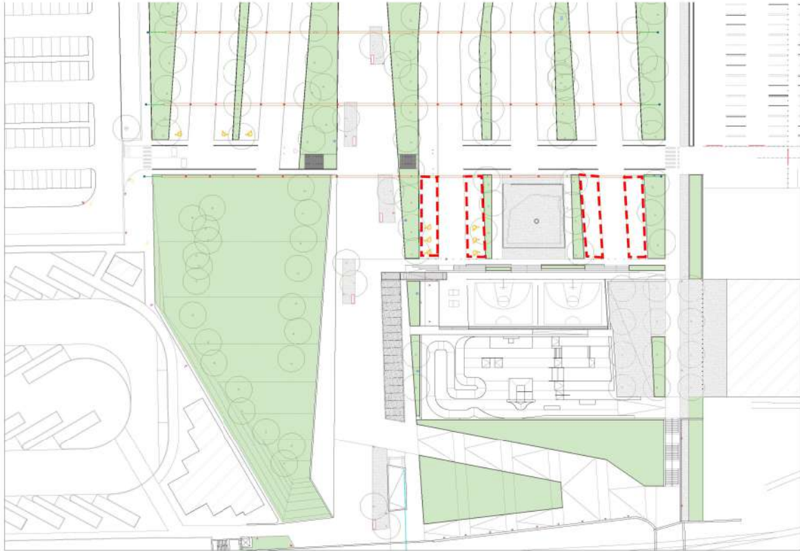
Figura 2: le aree segnate in rosso corrispondono alla pavimentazione in autobloccante ipotizzata in sostituzione.
